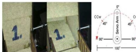
Gambar 6. Sudut Motor Servo Pada Gate
